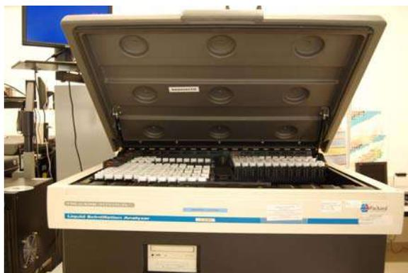
*Photo 8. Appareil à scintillation liquide*
